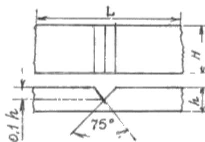
где  $h$  — толщина образца;  $H$  — ширина образца;  $L$  — длина образца
